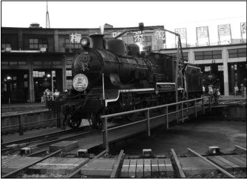
写真1 転車台で方向転換する8620形蒸気機関車
